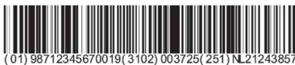
ภาพที่ 7 บาร์โค้ดในระบบ GS1-128 ของชิ้นส่วนเนื้อหาจากโรงฆ่าสัตว์ (EAN International, 2000)
